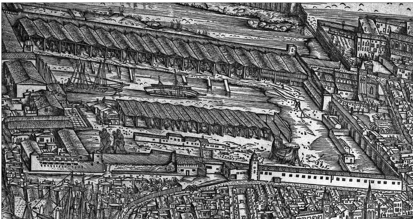
1. Veduta prospettica di Jacopo de Barbari (1500), particolare dell'Arsenale nuovo. Nella parte superiore si possono osservare i diciotto squeri trecenteschi dell'Isolotto; in quella al centro i dodici quattrocenteschi. Di questi ultimi i primi due da sinistra sono cantieri acquatici (Biblioteca Nazionale Marciana).
